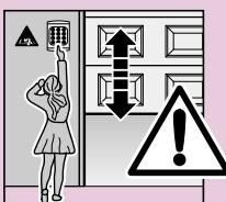
**Неподвижно установленные устройства управления (клавищные выключатели и т. п.) должны быть смонтированы на расстоянии видимости ворот, однако, в стороне от движущихся частей ворот и на высоте не менее 1,5 м. Они должны быть обязательно смонтированы на высоте, недоступной для детей!**
